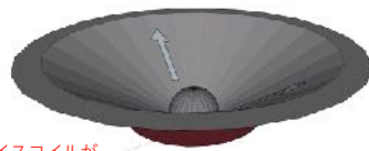
中央のボイスコイルが振動する
